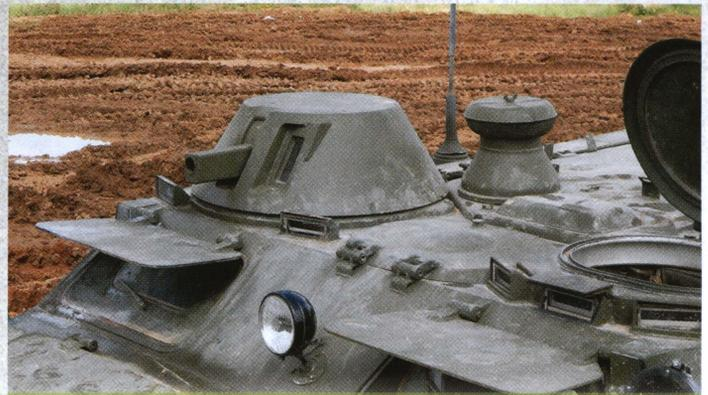
Башня МТ-ЛБ (пулемет ПКТ снят). Справа от нее находится люк для посадки командира машины. За башней виден корпус воздухозаборной трубы.
