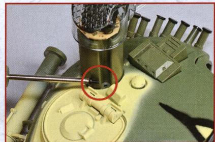
**7** Вставьте второй винт в крепежное отверстие на ИК-приемнике, как показано на снимке.
