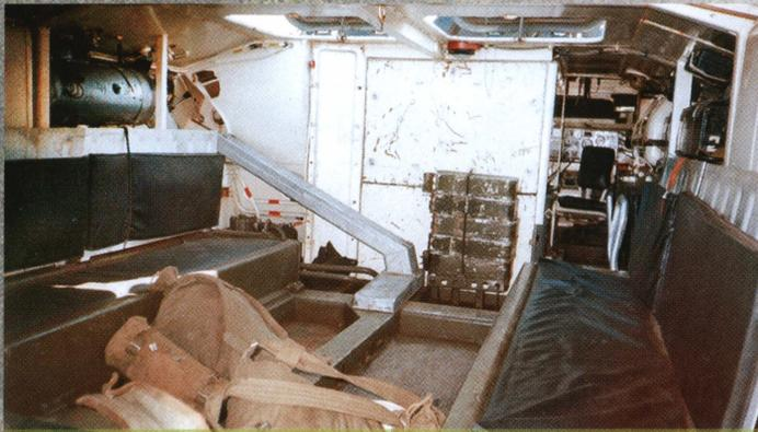
Внутренний вид транспортера-тягача МТ-ЛБ: справа и слева — сиденья для десанта, впереди слева — стенка моторного отделения, справа от нее — проход в отделение управления и место командира машины.
