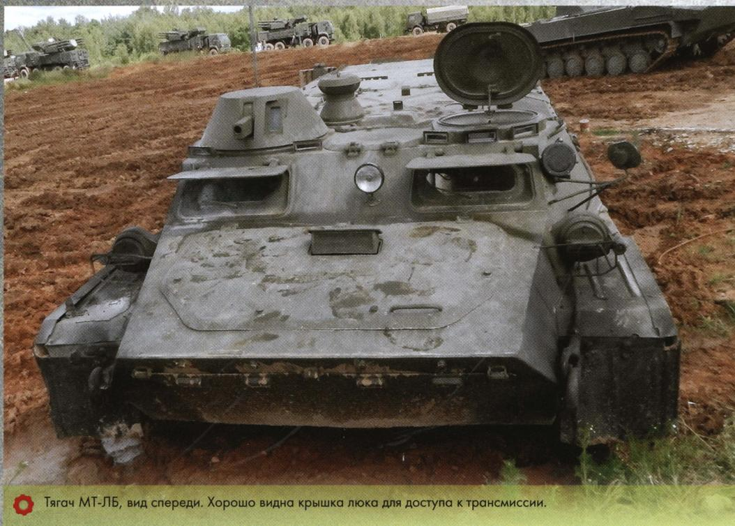
Тягач МТ-ЛБ, вид спереди. Хорошо видна крышка люка для доступа к трансмиссии.
