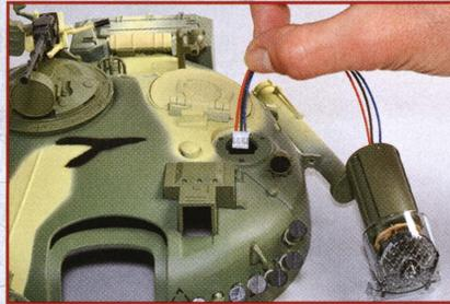
**3** Аккуратно просуньте контактный провод от ИК-приемника в отверстие на башне танка, как показано на снимке.
