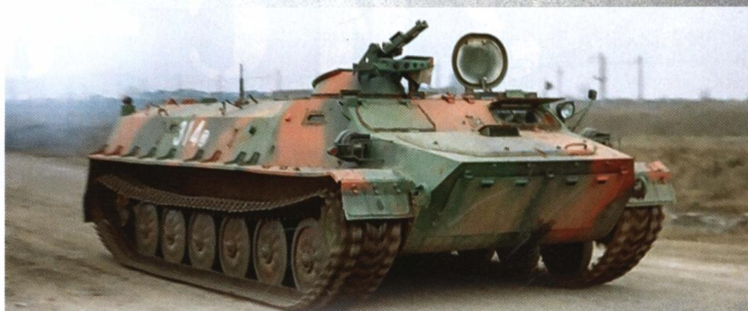
Вариант транспортера-тягача МТ-ЛБВ-М с уширенной гусеницей и установкой 12,7-мм пулемета НСВ.
