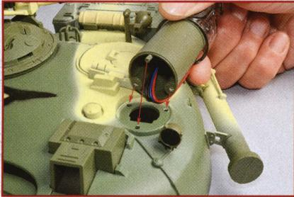
**2** Перед установкой ИК-приемника внимательно изучите данный снимок. На нем показано, как правильно должны располагаться крепления на ИК-приемнике относительно пазов на башне танка. Крепления должны четко вставать в пазы и надежно там фиксироваться даже без винтов.
