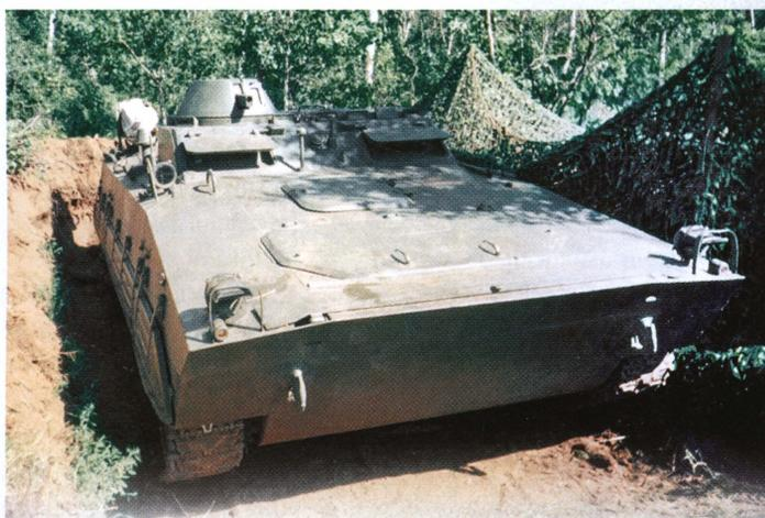
Разведывательная химическая машина «Кашалот», созданная на шасси МТ-ЛБ.
