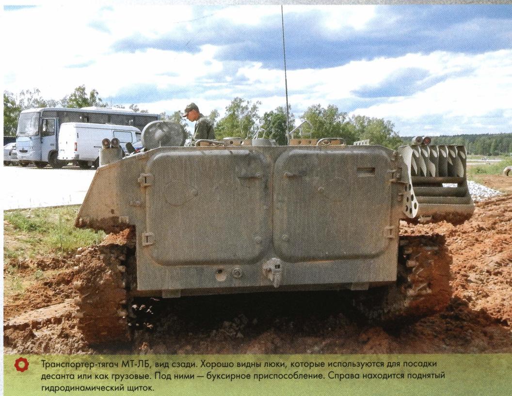
Транспортер-тягач МТ-ЛБ, вид сзади. Хорошо видны люки, которые используются для посадки десанта или как грузовые. Под ними — буксирное приспособление. Справа находится поднятый гидродинамический щиток.
