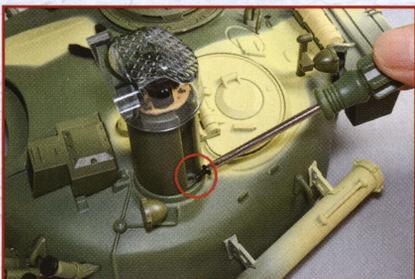
**5** Вставьте винт в крепежное отверстие на ИК-приемнике, как показано на снимке.
