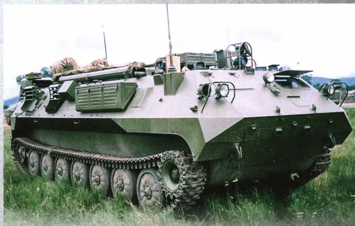
Универсальное гусеничное шасси МТ-ЛБу «Маргаритка». Хорошо видно, что машина имеет удлиненную (по сравнению с МТ-ЛБ) ходовую часть и корпус увеличенного размера.
