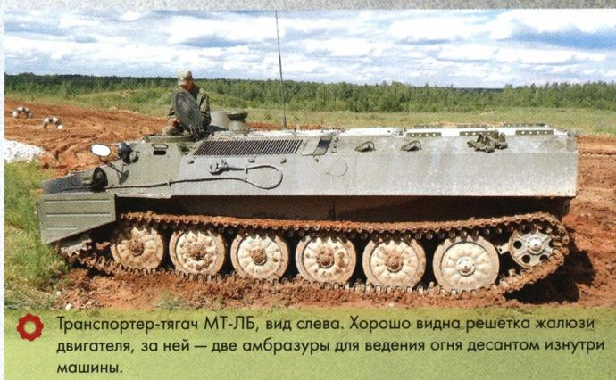
Транспортер-тягач МТ-ЛБ, вид слева. Хорошо видна решетка жалюзи двигателя, за ней — две амбразуры для ведения огня десантом изнутри машины.
