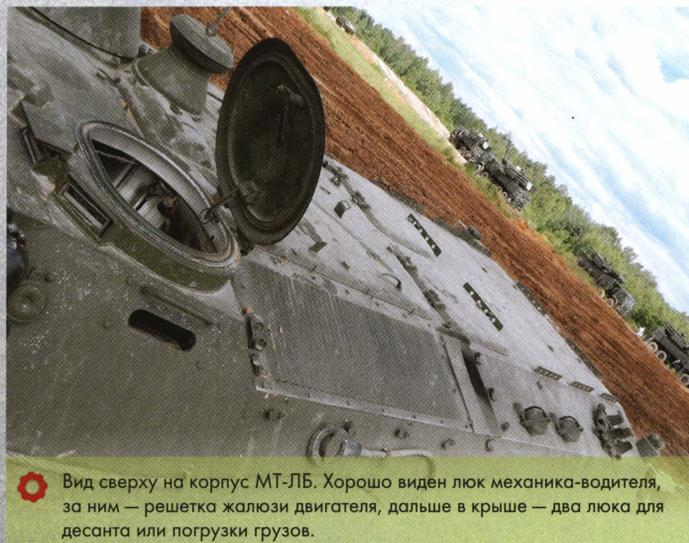
Вид сверху на корпус МТ-ЛБ. Хорошо виден люк механика-водителя, за ним — решетка жалюзи двигателя, дальше в крыше — два люка для десанта или погрузки грузов.
