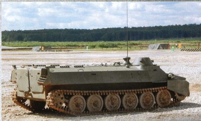
Транспортер-тягач МТ-ЛБ, вид справа. На корме находится гидродинамический щиток, который устанавливается перед преодолением водных преград на плаву.
